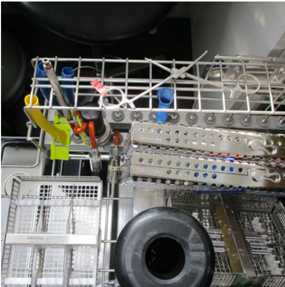
Abb. 4: Test 1: Detailansicht Lumcheck-Prüfkörper und Überprüfung des Spüldrucks
