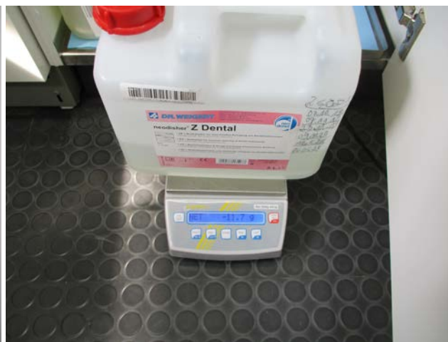
Abb. 11: Überprüfung der Dosierung (Neutralisator)
