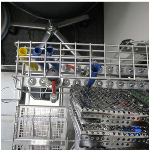
Abb. 8: Test 2: Detailansicht Überprüfung des Spüldrucks
